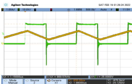
Figura 6. Señal de corriente del inductor (color amarillo) y señal de conmutación del transistor Q2 terminal drain. Voltaje de entrada 10V y corriente de salida 0.4 A.
