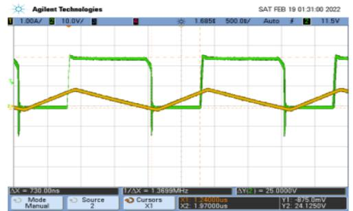
Figura 8. Señal de corriente del inductor (color amarillo) y señal de conmutación del transistor Q2 terminal drain. Voltaje de entrada 15V y corriente de salida 0.2 A.
