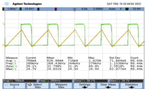
Figura 10. Señal de corriente del inductor (color amarillo) y señal de conmutación del transistor Q2 terminal *drain*. Medición hecha a  $V_{in} = 9.8V$  a una corriente de salida 0.3 A.
