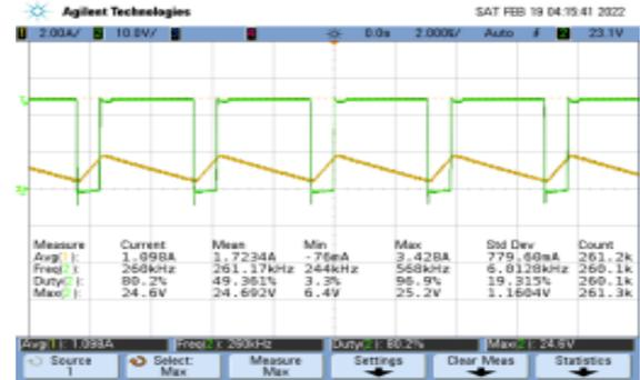
Figura 16. Señal de corriente del inductor (color amarillo) y señal de conmutación del transistor Q2 terminal *drain*. Medición hecha a  $V_{in} = 20V$  a una corriente de salida 0.9A. Modo de operación continuo.
