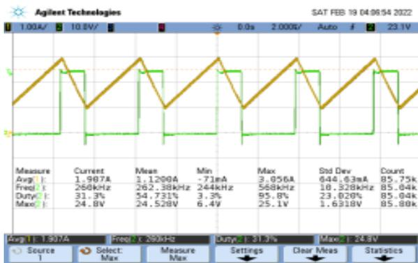
Figura 14. Señal de corriente del inductor (color amarillo) y señal de conmutación del transistor Q2 terminal *drain*. Medición hecha a  $V_{in} = 8.1V$  a una corriente de salida 0.6A. Modo de operación continuo.
