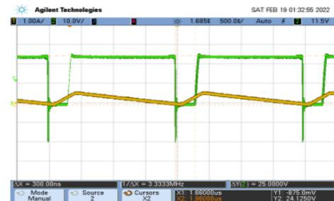
Figura 9. Señal de corriente del inductor (color amarillo) y señal de conmutación del transistor Q2 terminal drain. Voltaje de entrada 20V y corriente de salida 0.2 A.
