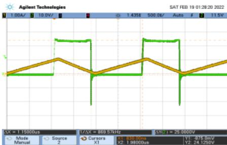
Figura 5. Señal de corriente del inductor (color amarillo) y señal de conmutación del transistor Q2 terminal drain. Voltaje de entrada 10V y corriente de salida 0.2 A.
