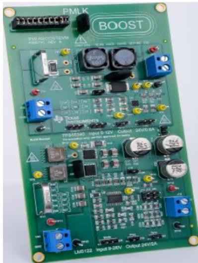
Figura 2. Vista superior de la tarjeta TI-PMLK-BOOST
