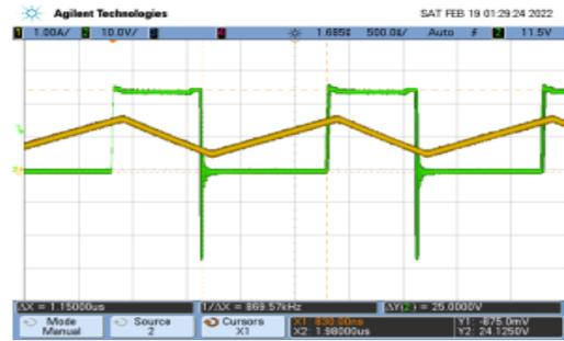
Figura 7. Señal de corriente del inductor (color amarillo) y señal de conmutación del transistor Q2 terminal drain. Voltaje de entrada 10V y corriente de salida 1.2 A.
