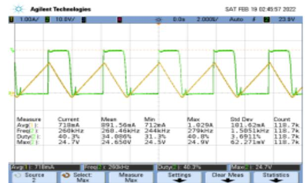
Figura 11. Señal de corriente del inductor (color amarillo) y señal de conmutación del transistor Q2 terminal *drain*. Medición hecha a  $V_{in} = 10.1V$  a una corriente de salida 0.3 A. Modo de operación crítico o CCM.
