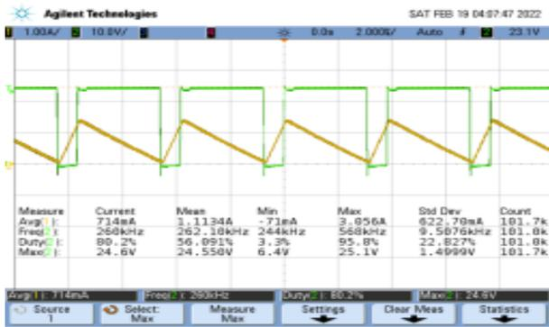
Figura 13. Señal de corriente del inductor (color amarillo) y señal de conmutación del transistor Q2 terminal *drain*. Medición hecha a  $V_{in} = 20V$  a una corriente de salida 0.6A. Modo de operación continuo.
